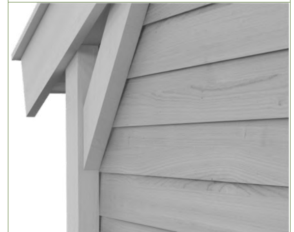
Zweeds rabat wandprofielen bij paal- constructies.
